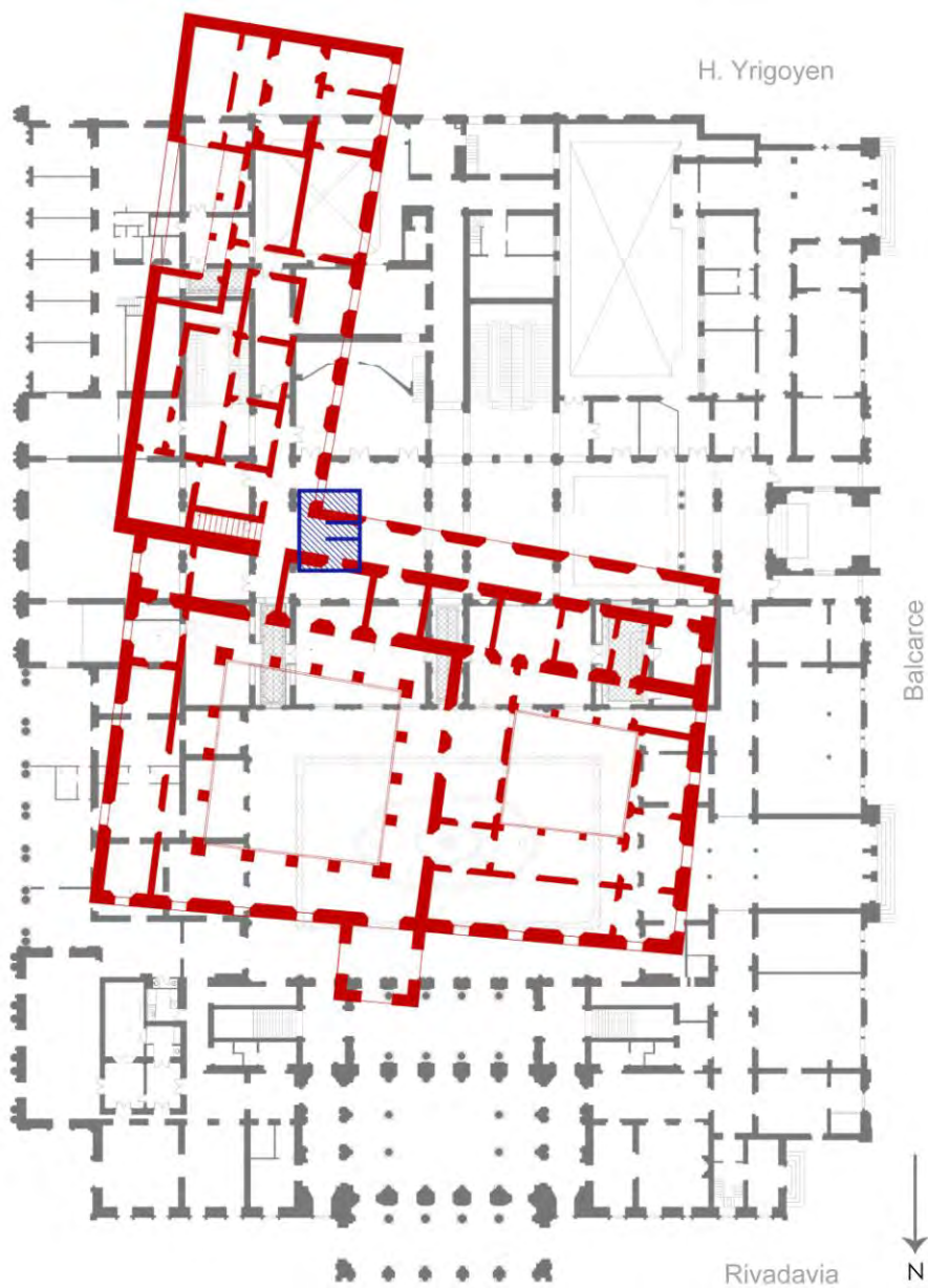
Figura 36. Planta del Palacio de los Gobernadores (según reconstrucción existente en archivo del IAA) superpuesta a la de Casa Rosada. En azul, la ubicación del sector de ascensores donde fueron halladas las estructuras. (Dibujo: F. Girelli).
