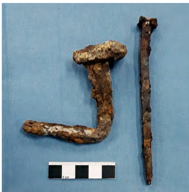
Figura 39. Dos variantes de clavos hallados en los rellenos: forjado (período colonial) y cortado con máquina (siglo XIX).
