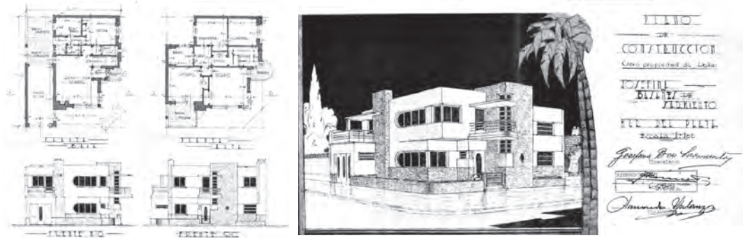
Figura 8: Vivienda Basaños, esquina de Gascón y Sarmiento, Mar del Plata (1939, actualmente demolida). Plano de construcción. En un terreno muy acotado, la ajustada planta se manifiesta volumétricamente como contraste de horizontales y verticales. Repositorio: Archivo Córscico Piccolini, Centro Documental CAPBA Distrito IX.
