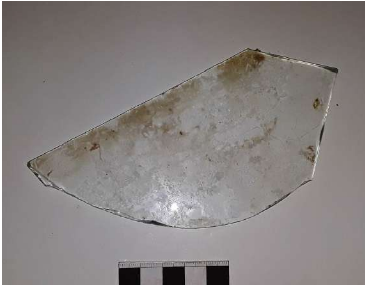
Ejemplo que muestra los intentos por generar una curva con pinza, por lo que se quebró el vidrio en la operación.
