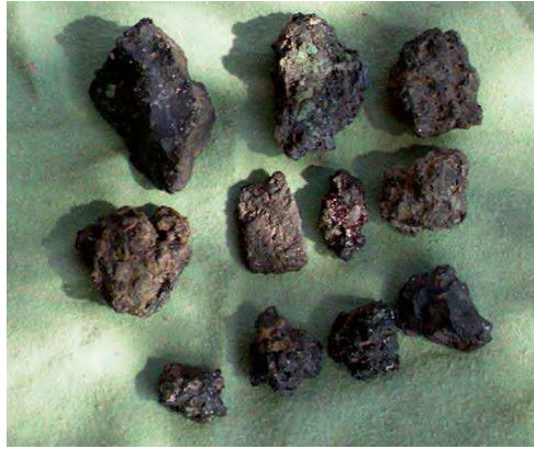
Figura 5. Ingenio Ampajango. Fragmentos de escoria (largo máximo del fragmento de arriba izquierda, 135 mm).
