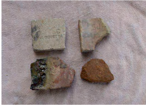
Figura 8. Ingenio Victoria. Distintos tipos de ladrillos refractarios (fragmento de arriba izquierda, largo máximo 135 mm).
