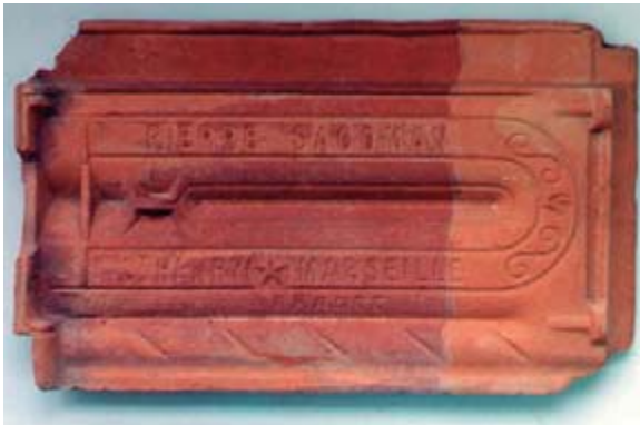
Figura 201. Teja francesa de finales del siglo XIX fabricada en Marsella, habitual para los techos de las ciudades, proviene de la excavación de la Usina Eléctrica de Palermo. [Archivo C.A.U.]
